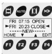
4. Sélectionnez le paramètre à modifier en appuyant sur F1(◀) et sur F4(▶) et changez-le en appuyant sur F2(▼) et F3(▲).
